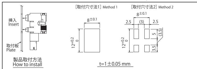
・取付板のプレス側から取付けを推奨します。
