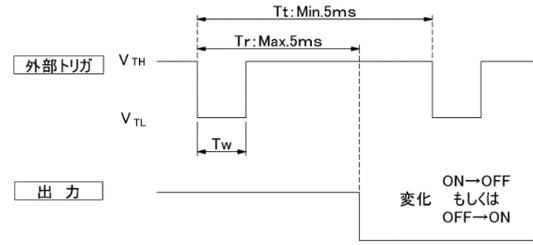
注) 外部トリガの  $V_{TH} \rightarrow V_{TL}$  のエッジでセンサは外部トリガが入力されたことを認識します
